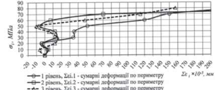
Рис. 10. Залежність сумарних деформацій по периметру куба на трьох рівнях від його основи (0,25 м, 0,15 м, 0,05 м) від напружень під штампом
