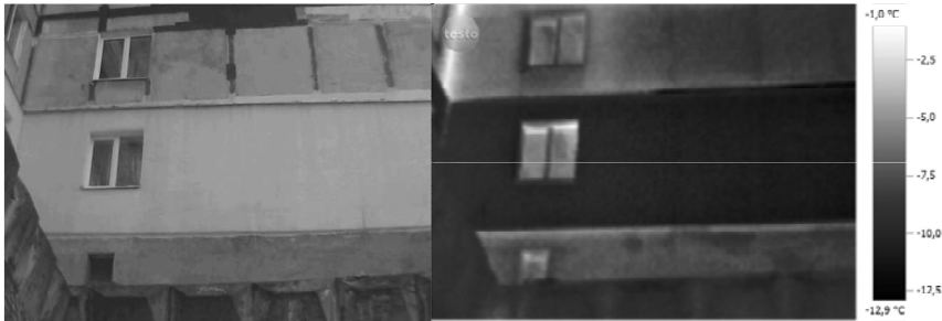
Рис. 1. Термограма зовнішньої стіни панельного житлового багатоповерхового будинку із фрагментарним утепленням
