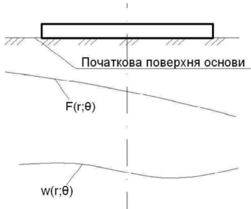
Рис. 3. Переміщення точок плити.
