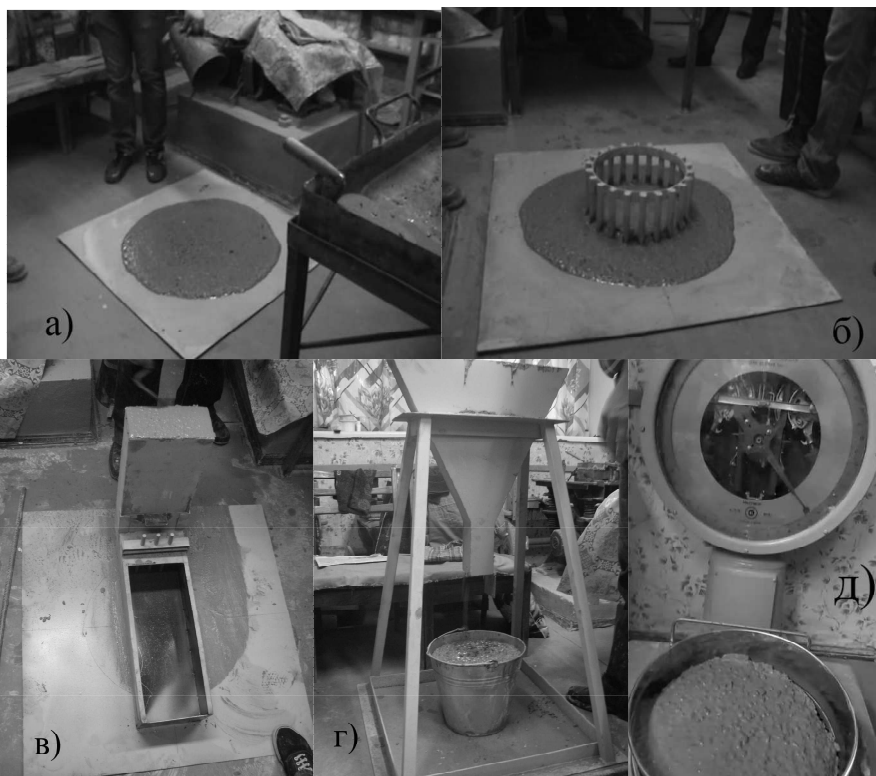
Рис. 1. Лабораторные испытания бетонной смеси: а) – определение расплыва конуса без кольца; б) – определение расплыва конуса с блокировочным кольцом; в) – испытание бетонной смеси в L-образном ящике; г) – испытание с использованием V-образной воронки; д) – испытание на устойчивость к расслаиванию путем просева через сито
