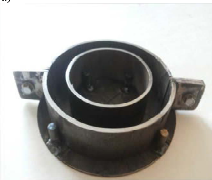
Рис. 3. Форма для визначення тріщиностійкості цементних композицій (а) та зразок після випробування (б)
