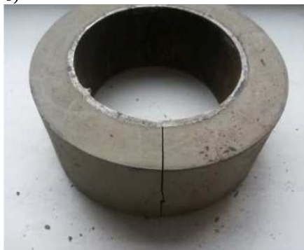
Рис. 3. Форма для визначення тріщиностійкості цементних композицій (а) та зразок після випробування (б)
