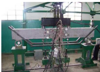
Рис. 2. Схема та розміщення вимірювальних приладів на дослідних балкових зразках.
