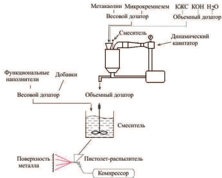
Рис. 3. Технологическая схема стационарной установки процесса приготовления атмосферостойкого геоцементного покрытия
