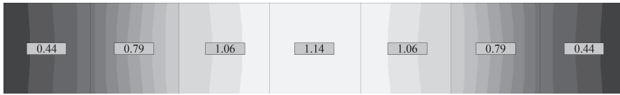
Рис. 7. Діаграма згинальних моментів M_x в плитних елементах конструкції, кН·м
