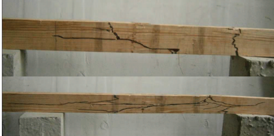
Рис.7. Характер руйнування балки Б-4
