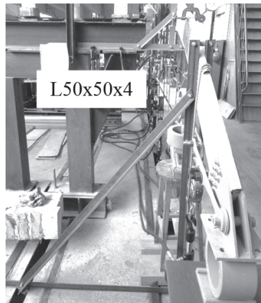
Рис. 3. Система забезпечення стійкості арки з площини
