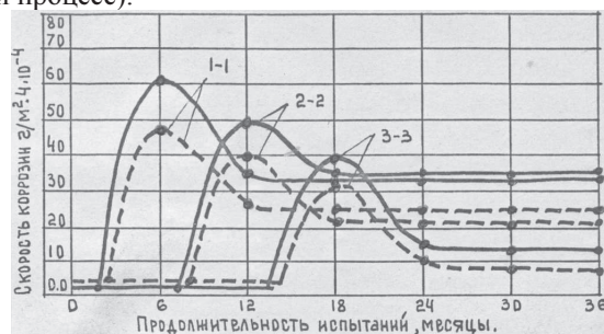
Рис.5. Скорость коррозии стальных стержней при испытании фуранового полимербетона на щебне из боя кислотоупорного кирпича в 5% растворе H_2SO_4 : ---- термообработанные образцы; — образцы нормального твердения; 1-1 – при толщине защитного слоя – 7 мм; 2-2 – то же – 15 мм; 3-3 – то же – 20 мм
