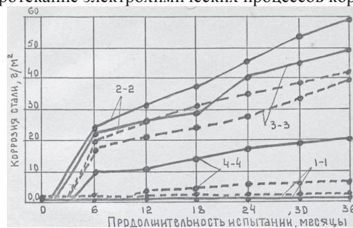
Рис.1. Кинетика коррозии стальных стержней в фурановом полимербетоне на щебне из боя кислотоупорного кирпича при толщине защитного слоя 7 мм: ---- термообработанные образцы; — образцы нормального твердения; 1-1 – в воздушно-сухих условиях; 2-2 – в 5% растворе H 2 SO 4 ; 3-3 – в 20% растворе H 2 SO 4 ; 4-4 – в 30% растворе H 2 SO 4 (Растворы H 2 SO 4 с t=60 0 C)
