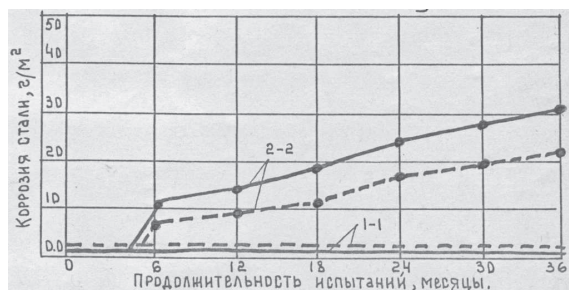
Рис.4. Кинетика коррозии стальных стержней в фурановом полимербетоне на гранитном щебне при толщине защитного слоя 15 мм: ---- термообработанные образцы; — образцы нормального твердения; 1-1 – в воздушно-сухих условиях; 2-2 – в воде
