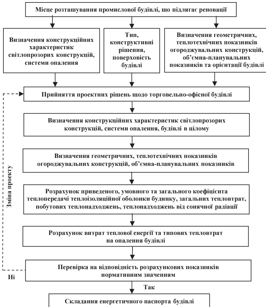
Рис. 1. Алгоритм визначення розрахункових параметрів та складання енергетичного паспорта торговельно-офісних будівель, сформованих при реновації
