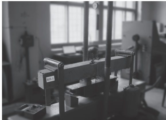
Рис. 1. Випробувальна установка з дослідною балкою
