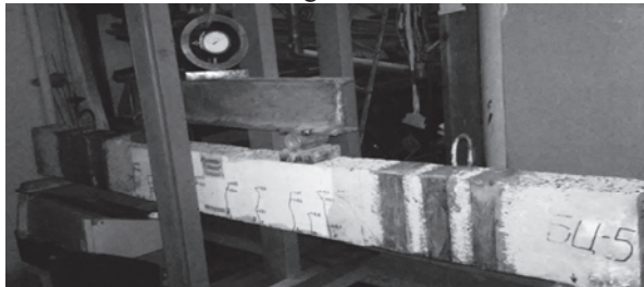
Рис. 8 Загальний вигляд балки підсиленої системами Sika® CarboDur® S-512 та SikaWrap®-230 C/45 під навантаженням
