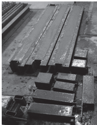
Рис. 2. Зразки балок та супутні зразки призм та кубів після бетонування
