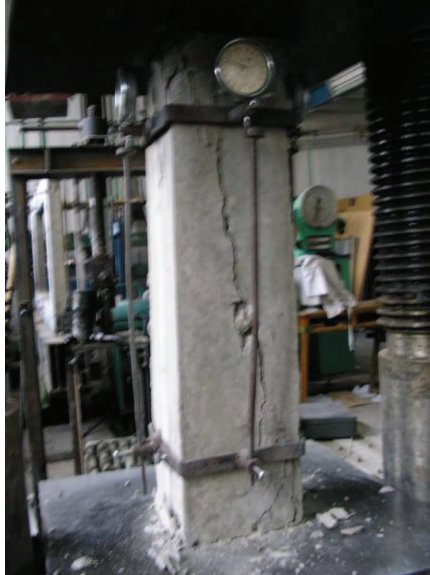
Рис. 2. Характер руйнування призм
