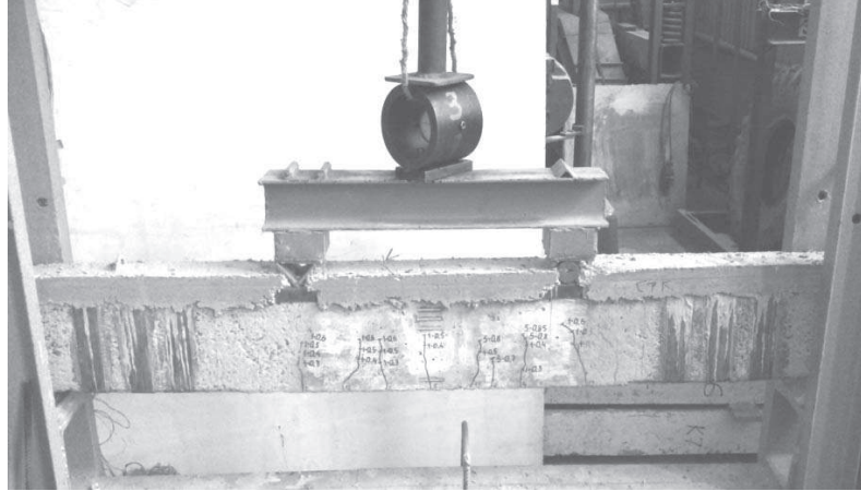
Рис.3. Підсилення дослідної балки БЦ-6 під навантаженням 0,6F_u
