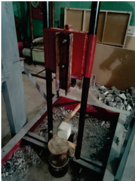
Рис. 2 – Експериментальні дослідження на пробивання: а) загальний вигляд установки при дослідженнях на пробивання; б) загальний вигляд експериментальних зразків безпосередньо перед випробуванням; в) ударний бойок у вигляді патрону ДШК
