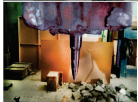
Рис. 2 – Експериментальні дослідження на пробивання: а) загальний вигляд установки при дослідженнях на пробивання; б) загальний вигляд експериментальних зразків безпосередньо перед випробуванням; в) ударний бойок у вигляді патрону ДШК
