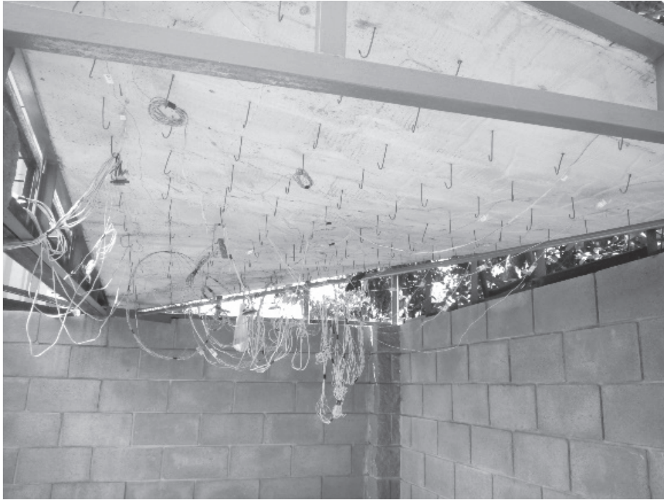
Рис. 2. Тонкостінна оболонка типу «гіперболічний параболоїд» зі сталевібробетону під час випробувань
