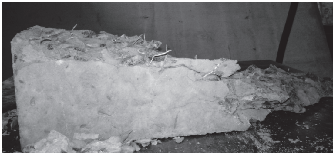
Рис.7. Вигляд руйнування зразка із фіброю після випробування з чіткими кінцями фібр
