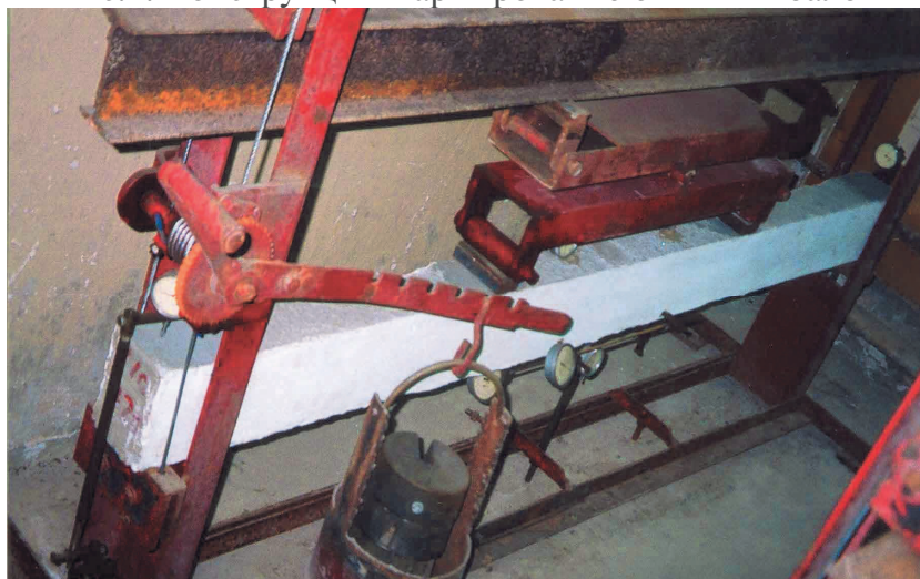
Рис. 2. Испытание балок длительно действующей нагрузкой.
