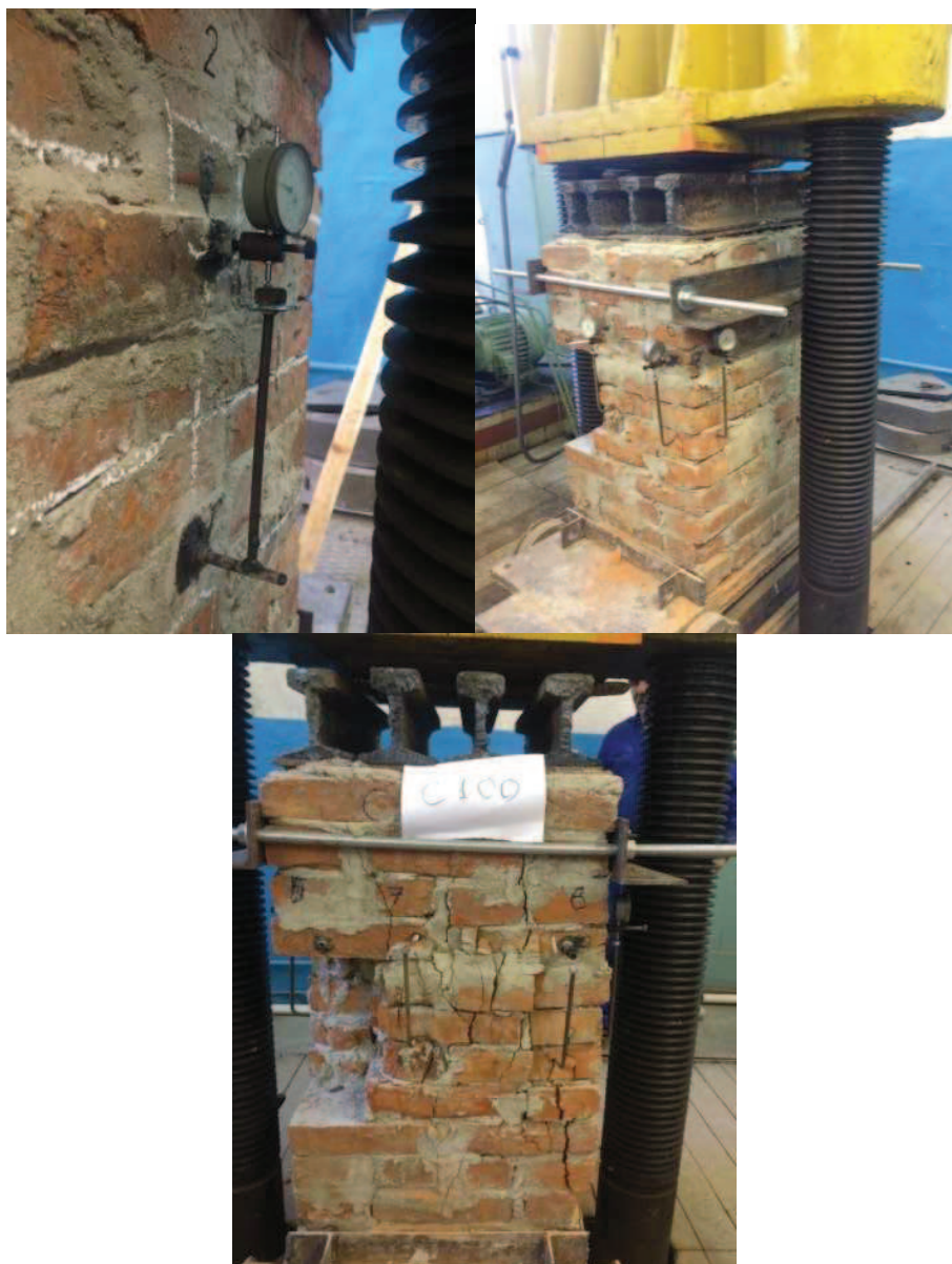
Рис.3 Випробування стовпів: а – розстановка індикаторів годинникового типу для визначення повздовжніх деформацій стовпів; б – зразок С 1 0 0 перед випробуванням; в – той же зразок після випробування.
