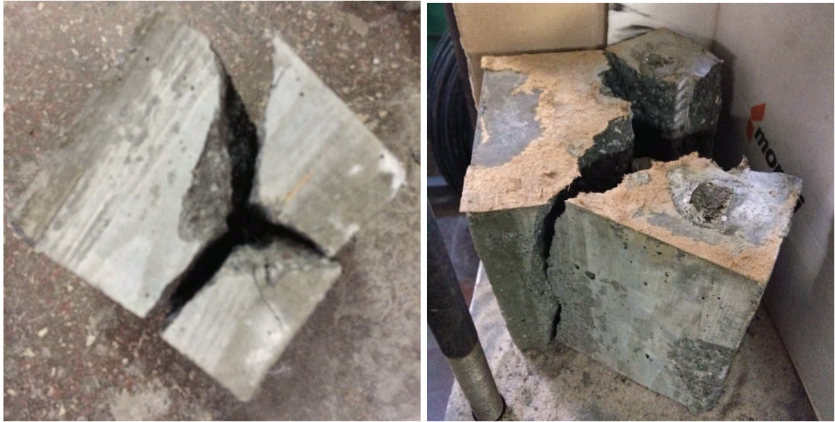
Рис. 3. Характер руйнування зразків з діаметром стержнів 16 мм
