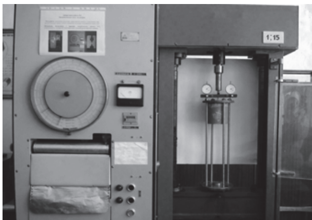
Рис. 2 Принципова схема випробування зчеплення склопластикової арматури з бетоном
