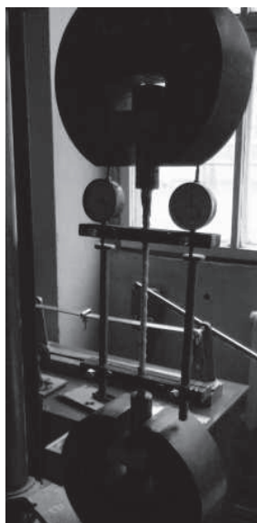
Рис. 1. Принципова схема закріплення вимірювального пристосування на зразку склопластикової арматури
