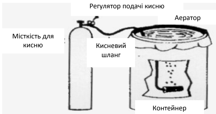
Рис. 6. Принципова схема живорибного автомобіля
