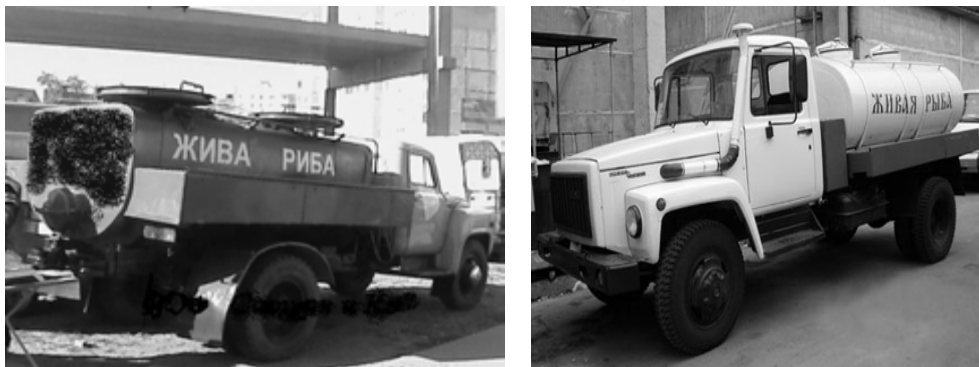
Рис. 1. Автомобілі для перевезення живої риби зразка 1954 р. та модель 473875 [1]
