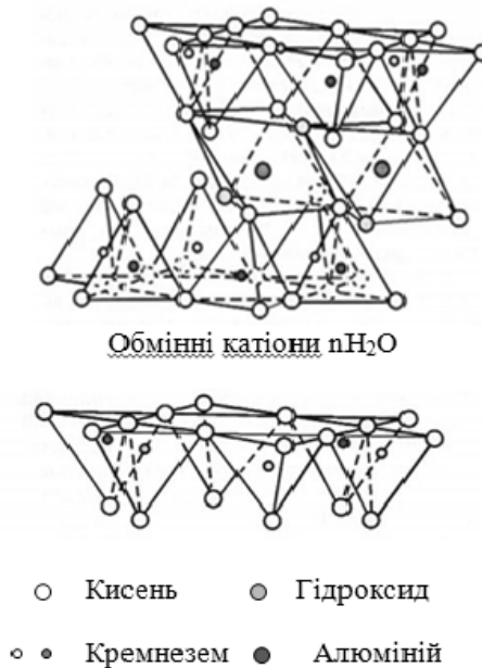
Рис. 6. Атомна структура бентоніту (монтморилоніту) [...] (за Гофманом, Енделлом, Вілмом, Маршалом і Хендріксом, 1933 р.)
