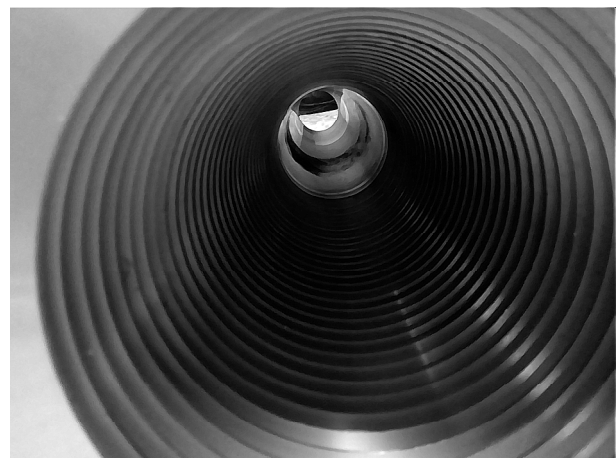
Рис. 3. Гофрированный рупор облучателя АС MARK-4B
