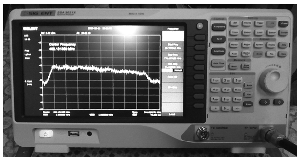
Рис. 9. АЧХ первого канала “теплого” радиометра
