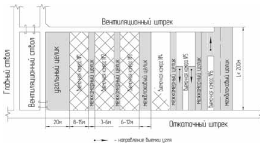
Рис. 2. Ведение горных работ при камерной системе разработки
