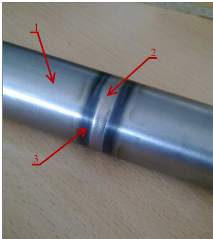
1 – основний метал; 2 – зварний шов; 3 – зона термічного впливу
