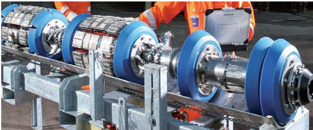
Рисунок 6 – Діагностичний пристрій RosenRoCD² DN 400 мм для визначення тріщин і відшарування ізоляції трубопроводу
