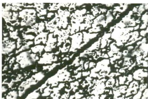
Рисунок 2 – Зародження поверхневих мікротріщин (а) і утворення макротріщини (б) на циклічно деформованих зразках з неексплуатованої сталі 17Г1С у ході випробувань у середовищі з рН = 6,7
