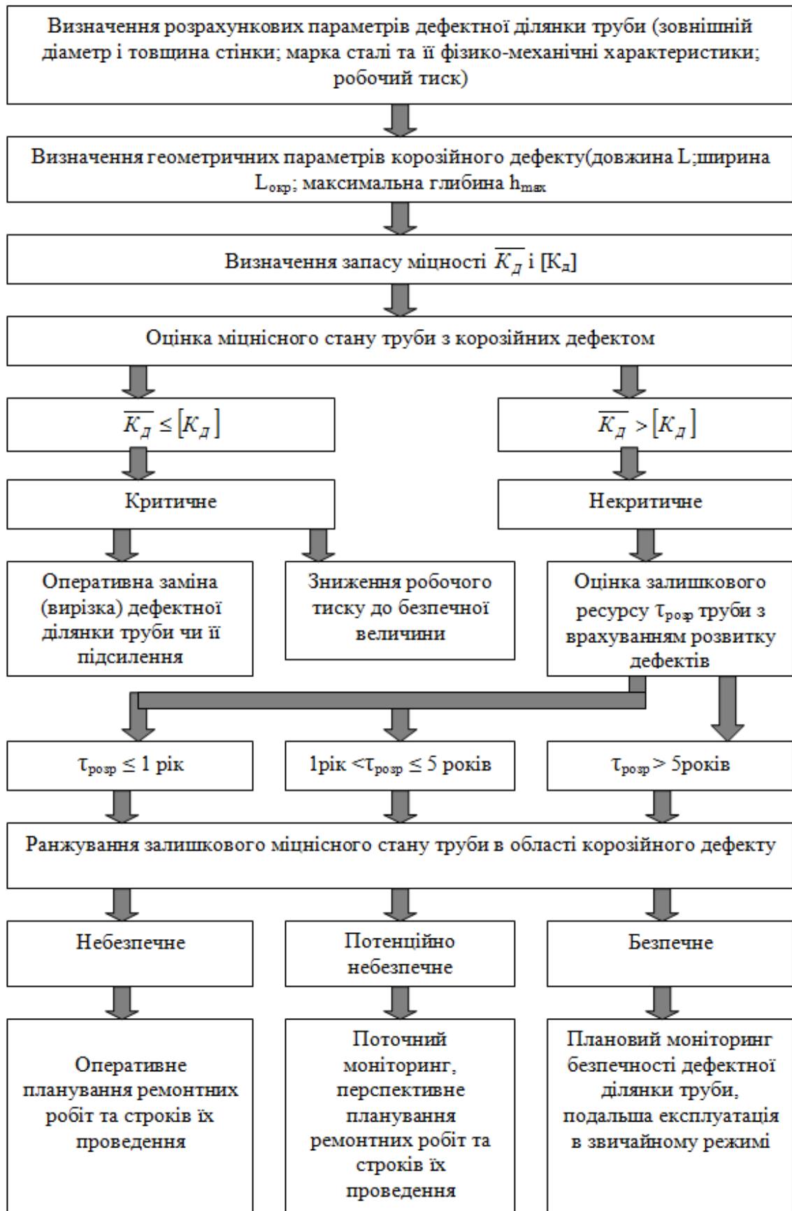
Рисунок 4 – Методична схема прогнозування залишкового ресурсу газопровідних труб з корозійними пошкодженнями
