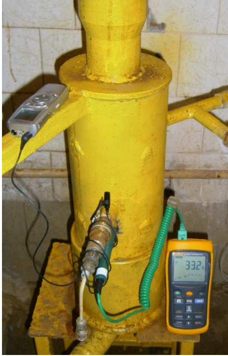
Рисунок 5 – Вимірювання процесу поширення температури та акустичних хвиль удосконаленого гідравлічного генератора імпульсно-хвильової дії за допомогою термометра FLUKE 54 II та диктофона OLYMPUS VN-480PC
