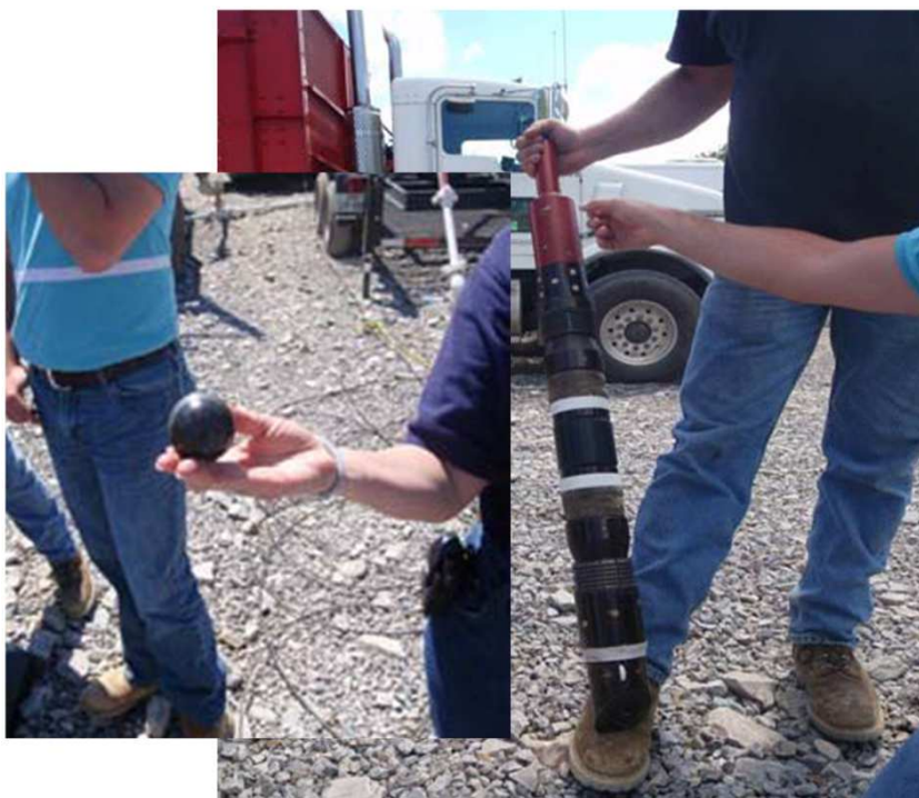
Рисунок 7 – Загальний вигляд кулькового пакера компанії Weatherford
