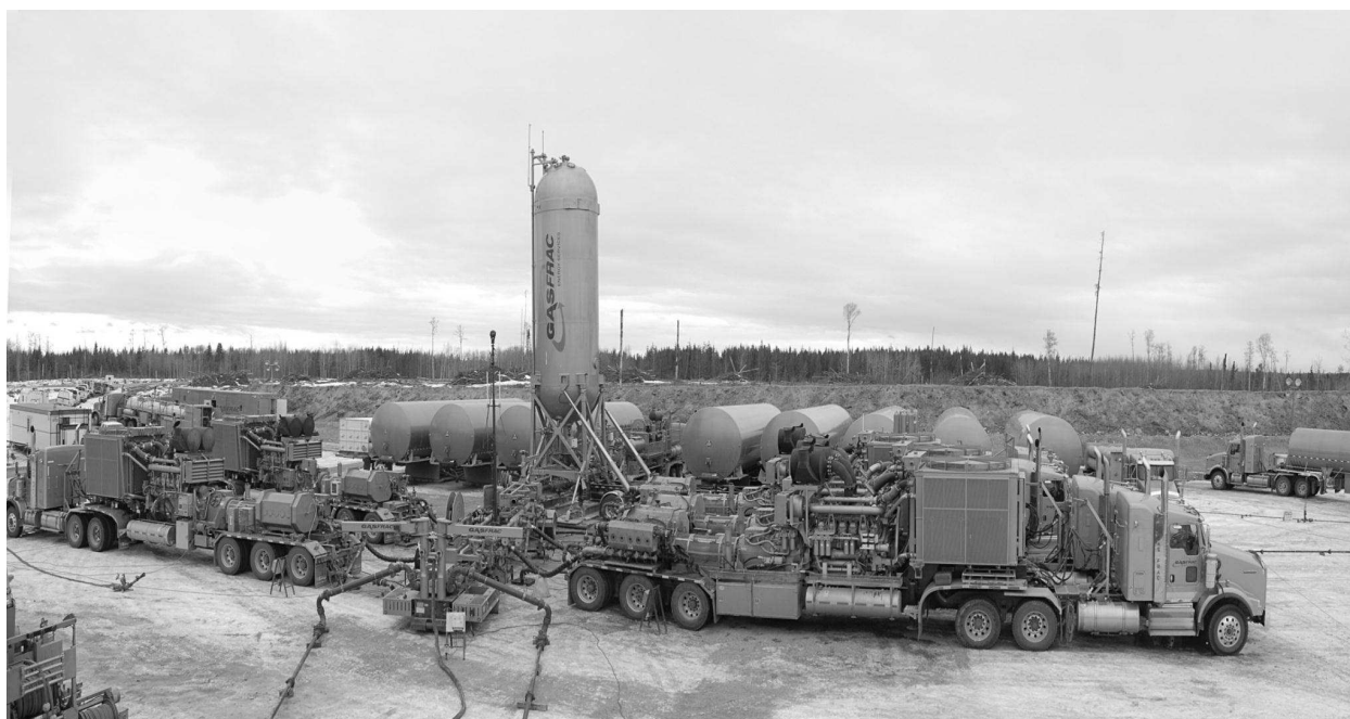
Рисунок 11 – Обв'язка гирла свердловини та розташування техніки при проведенні безводного ГРП
