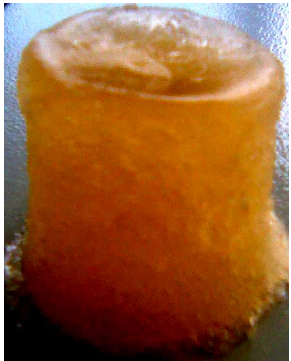
Рисунок 14 – Утворення еластичної плівки на поверхні зразка поршня після оброблення гелю метиловим спиртом
