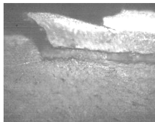
Рисунок 7 – Типове відшарування фрагментів цементованого шару (×500)
