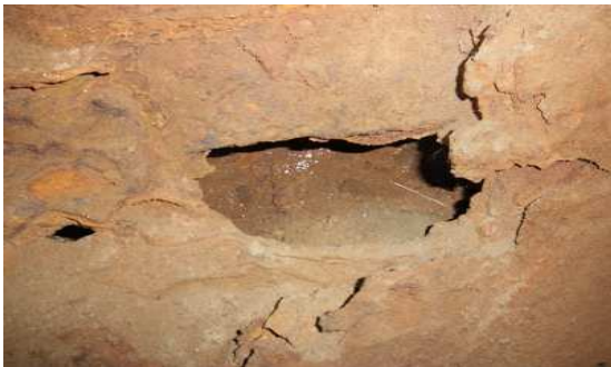
Рисунок 1 – Наскрізна корозія нижніх твірних обичайки, в місці входу продукції свердловин нафтогазового сепаратора НГС-1-1,0-3000-2
