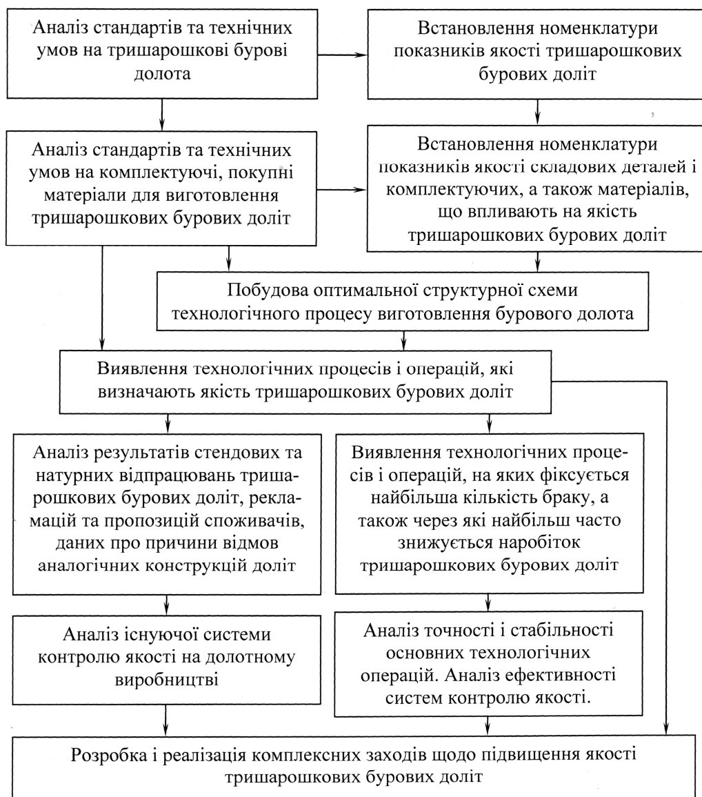
Рисунок 4 – Схема виявлення параметрів елементів технологічної системи, які визначають якісні показники тришарошкових бурових доліт
