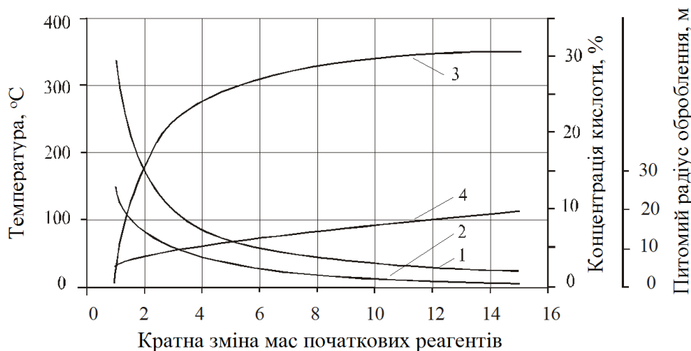
Рисунок 2 – Залежність температури розчину (1) та пласта (2), залишкової концентрації \text{HNO}_3 (3) та питомого радіусу зони оброблення (4) від зміни мас \text{NH}_4\text{NO}_3 та \text{CH}_2\text{O}
