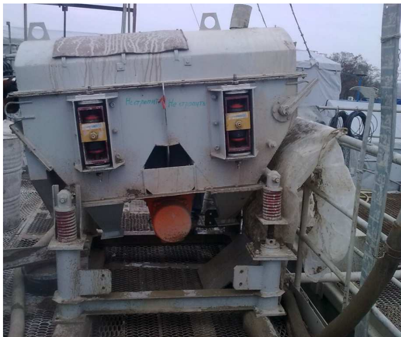
Рисунок 4 – Грохот МВГ в технологии очистки бурового раствора на буровой «Володарская-2» ПАО «Шахта им. А.Ф. Засядько»
