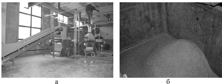
Рис. 1. Фото линии Eldan E2000С гранулирования и разделения медных и полимерных отходов – а; гранулы меди – б
