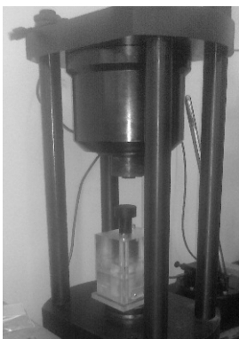
Рис.3. Установка для винтовой экструзии пластилиновых образцов через плексигласовую матрицу
