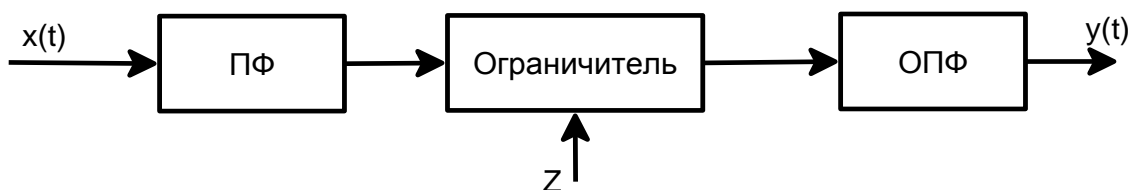
Рис. 1. Структурная схема нелинейного фильтра узкополосных сигналов
