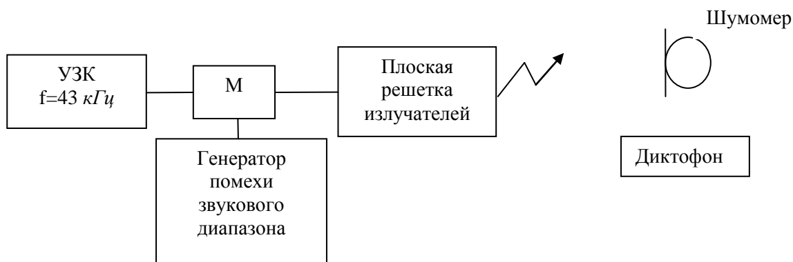
Рис. 2. Схема измерения уровня сигнала системы УЗИ
