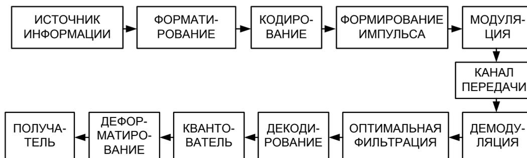
Рис. 2. Структурная схема исследуемой цифровой системы передачи информации
