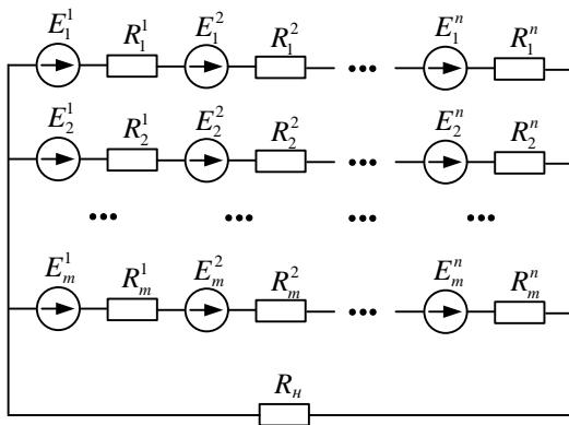
Рис. 4. Схема объединения ПВЭ по постоянному току
