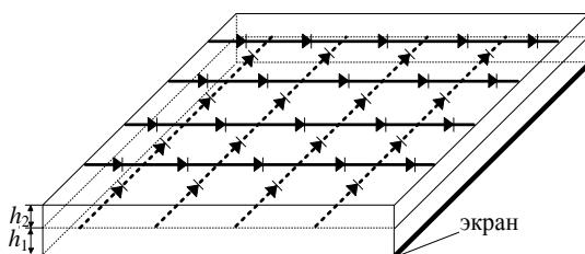
Рис. 5. Фрагмент ректенны работающей на ортогональных поляризациях
