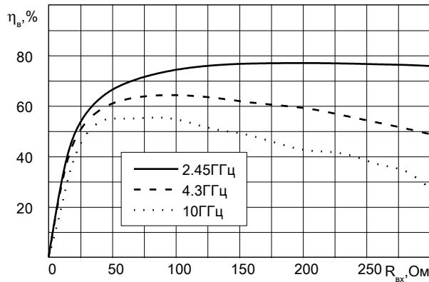
Рис. 2. Зависимость КПД выпрямления ПВЭ от его входного сопротивления
