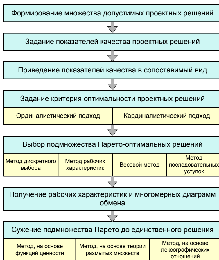
Рис. 1. Структура система поддержки принятия проектных решений, оптимальных по совокупности показателей качества
