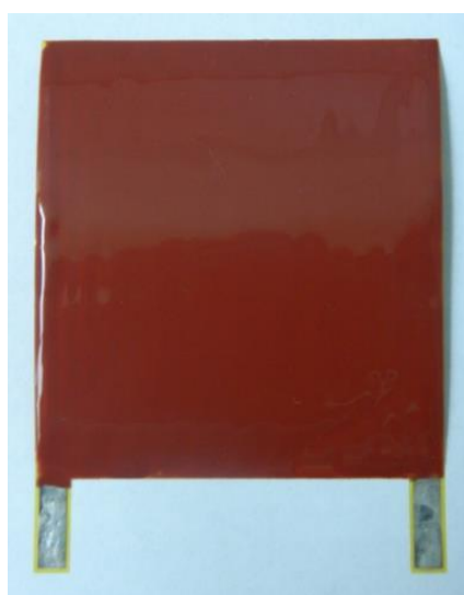
Рис. 6. Тестовый технологический образец электронагревателя с защитным покрытием
