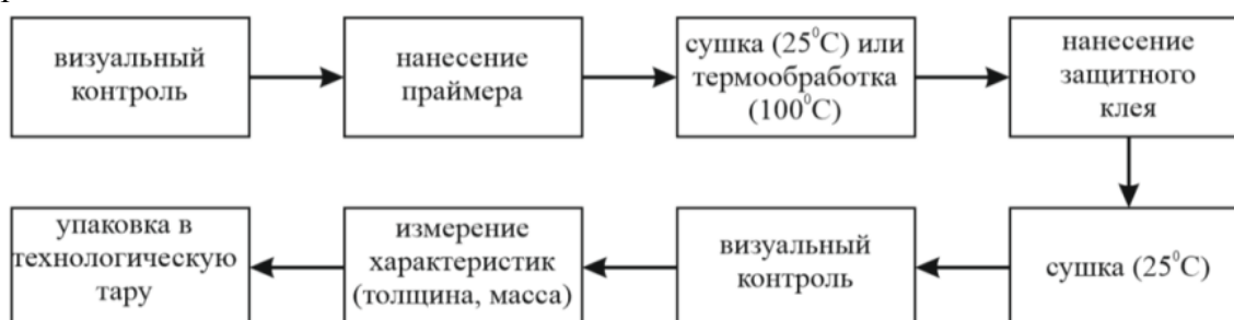
Рис. 5. Технологическая схема формирования защитного покрытия электронагревателя
