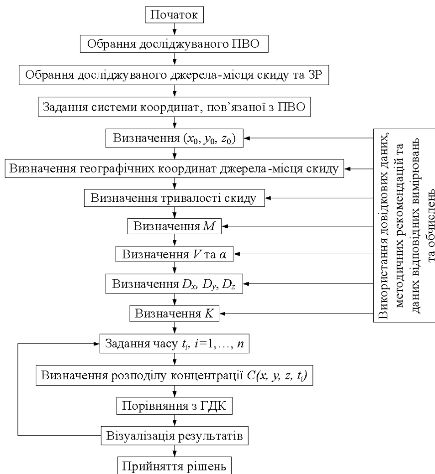
Рисунок 1 – Схема керуючого алгоритму за нестационарних умов скиду
