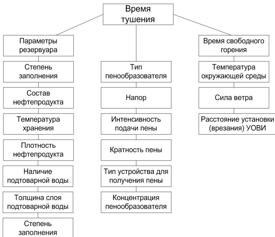
Рисунок 1 – Факторы, определяющие эффективность подслоного тушения
